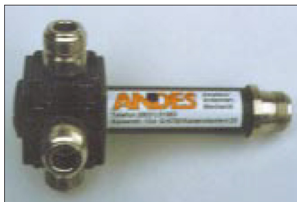
Figura 10 muestra un splitter de antena coaxial de cuatro salidas fabricado industrialmente (Andes). Está diseñado para la banda de 23 cm y, por lo tanto, tiene dimensiones muy manejables
