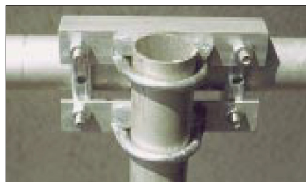
Figura 17: Realizzazione meccanica dei punti di collegamento dei tubi per una croce ad H con staffe in alluminio Foto: DK7ZB
