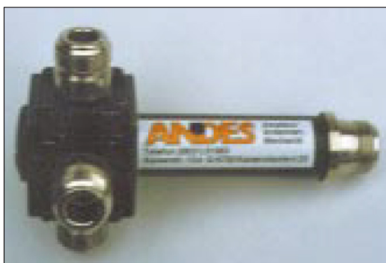
Bild 10: Kommerzieller Vierfachtopf für das 23 cm-Band (Fa. Andes)
