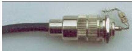
Figura 15: Resistenza di terminazione da 50 Ω fatta in casa per la misurazione degli elementi di accoppiamento
