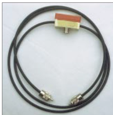
Bild 16: Fertiges Aufstockkabel für den Portaleinsatz
