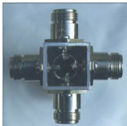
Bild 9: Blick in einen Vierfachverteiler
