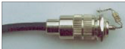
Bild 15: Selbstgebaute Abschlußwiderstand 50 \Omega zum Messen der Anpassung
