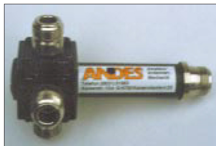
Figura 10: Splitter commerciale a quattro vie per la banda dei 23 cm (Andes)
