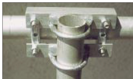
Figure 17: Réalisation mécanique des points de raccordement des tubes pour une croix en H avec équerres en aluminium Photos : DK7ZB
