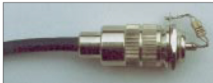
Figure 15: Résistance de terminaison maison de 50 \Omega pour mesurer les éléments correspondants
