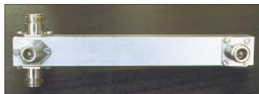
Figura 8: Accoppiatore quadruplo autocostruito per la banda dei 70 cm
