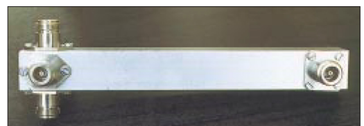
Bild 8: Selbstgebaute Vierfachverteiler für das 70-cm-Band
